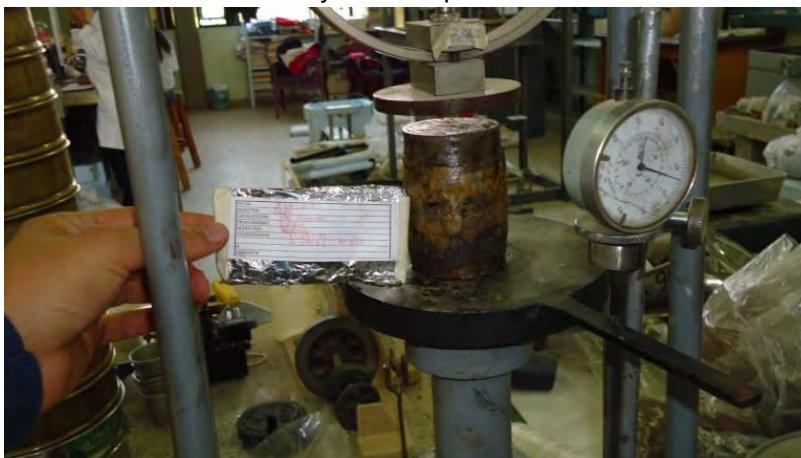
Fotografía 8. Muestra fallada en el ensayo de compresión no confinada.
