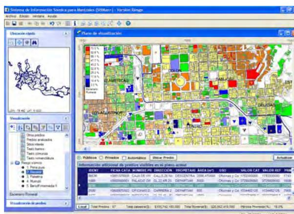
Figura 10. Ejemplo del escenario determinista de daño para un terremoto en una fuente sísmica específica, calculado usando el CAPRA.
