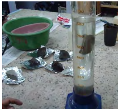
Fotografía 16. Medición de volumen de la muestra para establecer propiedades físicas de la roca.
