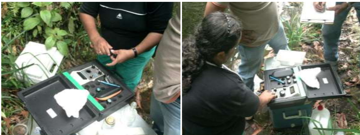
Figura 9. Análisis de la turbiedad del agua en la parte alta de la quebrada mediante el uso del turbilímetro
