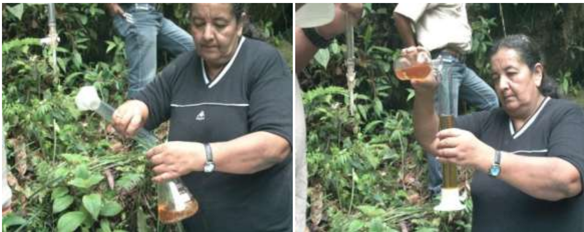
Figura 8. Análisis en campo del DBO5 en la parte alta de la quebrada mediante la aplicación de reactivos
