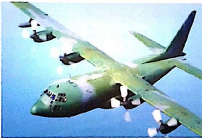
*Tipo de aeronave C130 para la penetración de los huracanes. Estas naves tienen una autonomía mayor a 10 horas para permanecer en vuelo. Hasta 6 veces pueden atravesar el ojo del huracán a diferentes alturas, dependiendo de la etapa del ciclón tropical.*
