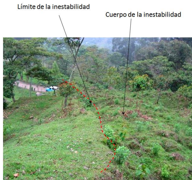
Foto 2.7. Detalle del material inestabilizado y cuya dirección de movimiento es hacia la vía veredal, nótese el cambio de textura y conformación de los suelos inestabilizados con respecto a los estables.
