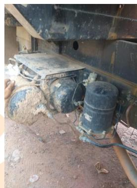
Filtro secador y tanques de aire
