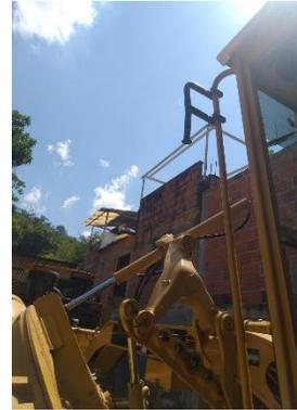
Cilindro de desplazamiento del círculo
