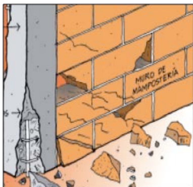
Roturas locales en mampostería. Fotografía tomada de: Manual de construcción, evaluación y rehabilitación sismo resistente de viviendas en mampostería
