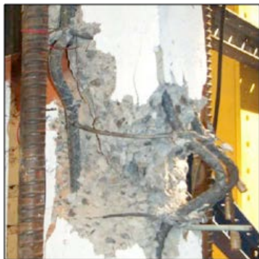
Deflexión y fractura del acero de refuerzo Fotografía tomada de: Metodología para la evaluación de la seguridad estructural de edificios, 2014
