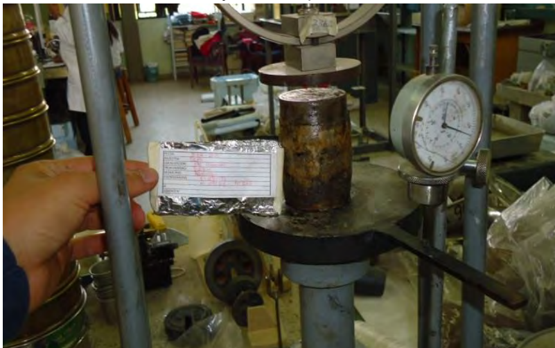
Fotografía 19. Muestra fallada en el ensayo de compresión no confinada.
