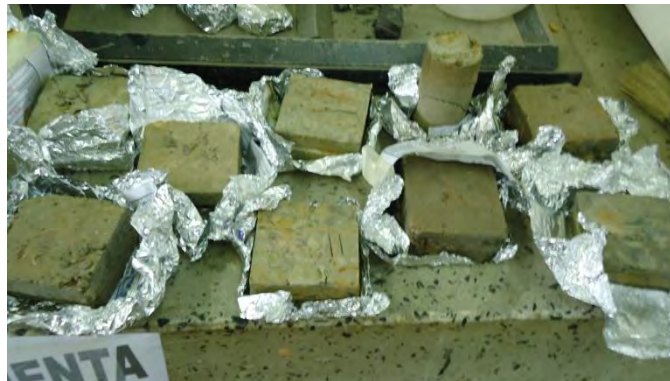
Fotografía 31. Muestras a las que se les realizo la prueba de corte directo.
