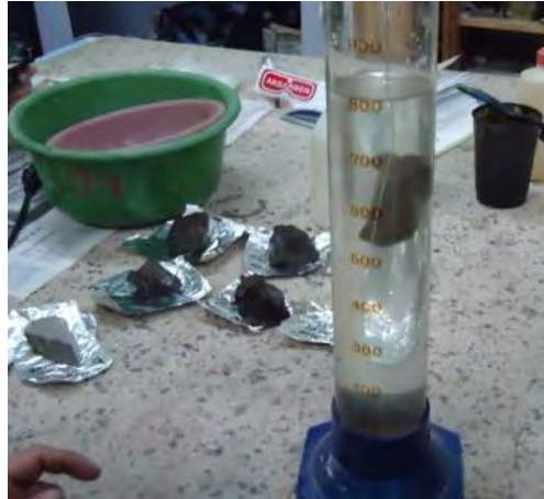
Fotografía 29. Medición de volumen de la muestra para establecer propiedades físicas de la roca.
