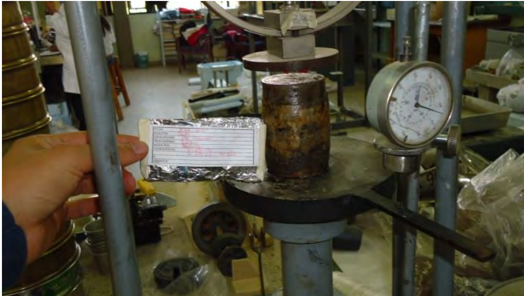
Fotografía 30. Muestra fallada en el ensayo de compresión no confinada.
