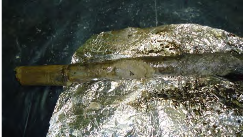
Fotografía 37. Superficie de falla localizada en la recuperación de material obtenido en la perforación.
