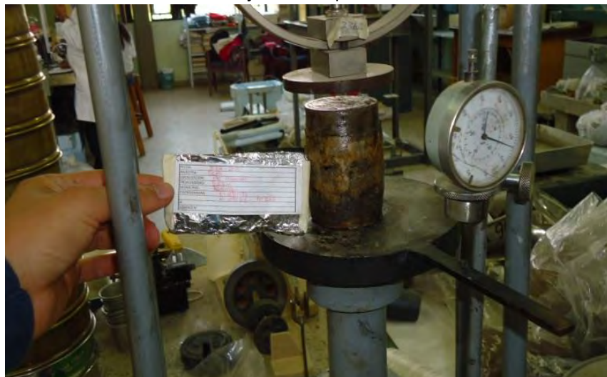
Fotografía 18. Muestra fallada en el ensayo de compresión no confinada.
