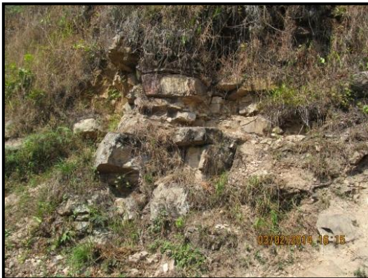
Fotografía 6.1 Exposición de las areniscas de la formación Barco en condición de roca muy fracturada
