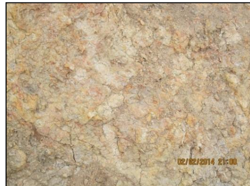
Fotografía 6.9 Vista de los niveles de limolitas muy meteorizadas y fracturadas, expuestas en la parte alta y media de la zona del deslizamiento
