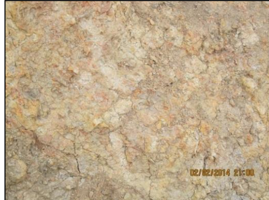
Fotografía 6.11 Vista de los niveles de limolitas muy meteorizadas y fracturadas (w3- w4) de la unidad KI-1 expuestas lateralmente al cuerpo del deslizamiento.
