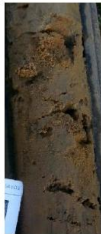
Fotografía 7.19 Suelo residual de lutita – sondeo S6
