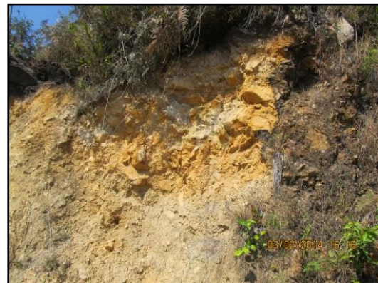
Fotografía 6.1 Exposición de las areniscas de la formación Barco en condición de roca muy fracturada
