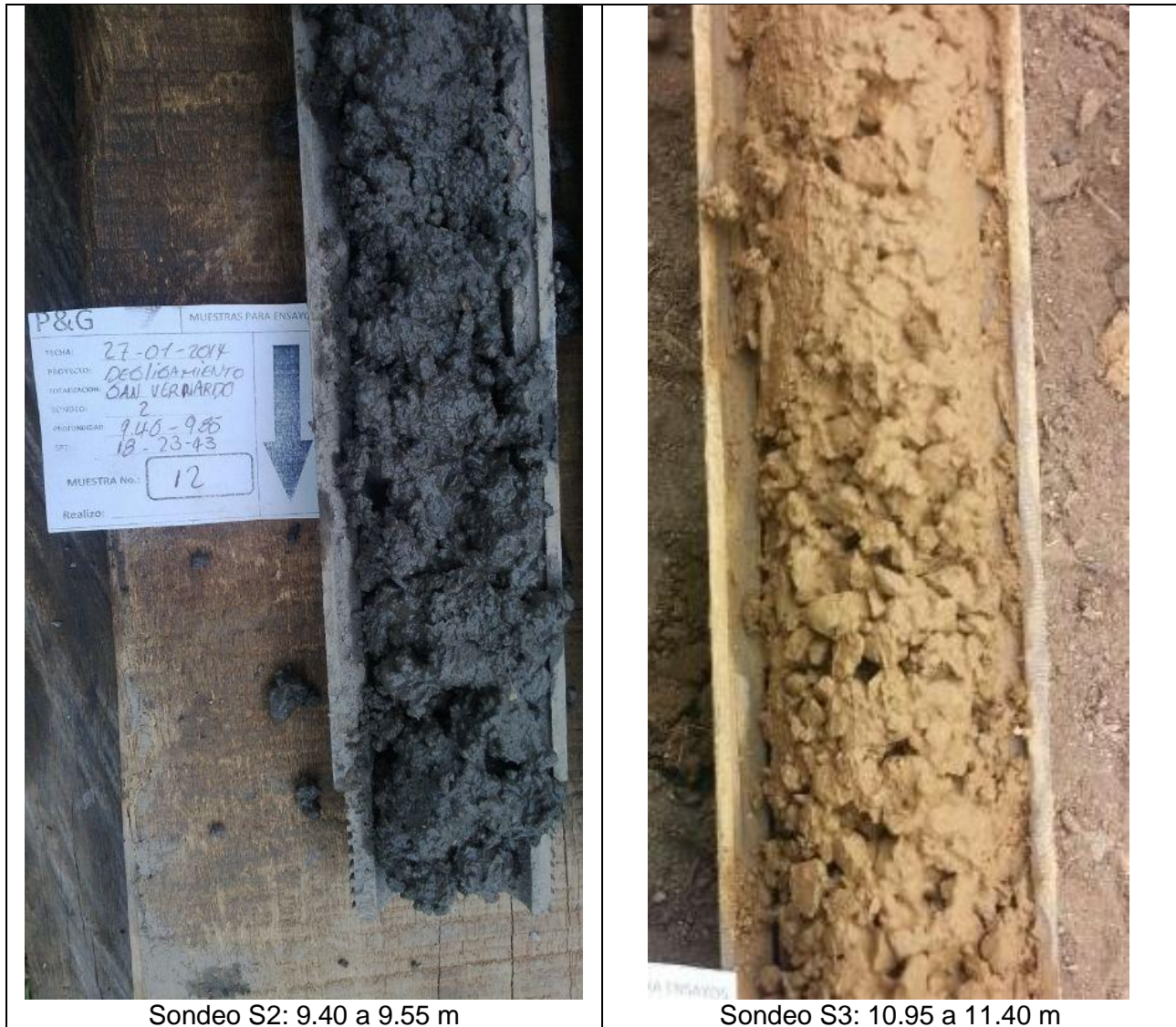
Fotografía 7.14 Zona de contacto movimiento depósito coluvial – roca diaclasada
