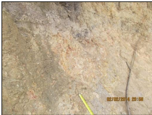
Fotografía 6.9 Vista de los niveles de limolitas muy meteorizadas y fracturadas, expuestas en la parte alta y media de la zona del deslizamiento
