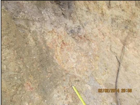
Fotografía 6.11 Vista de los niveles de limolitas muy meteorizadas y fracturadas (w3- w4) de la unidad KI-1 expuestas lateralmente al cuerpo del deslizamiento.
