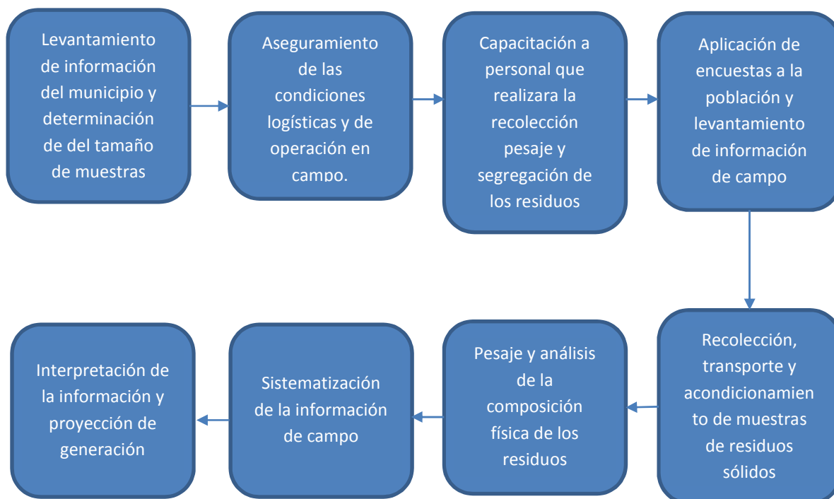
Ilustración 4. Secuencia lógica de intervención para la realización del Estudio de caracterización de residuos sólidos.
